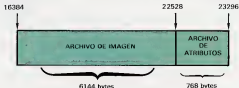
La zona de memoria denominada AREA DE ATRIBUTOS, contiene toda la información referente al color de la pantalla.
