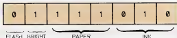
Cada byte del área de atributos, codifica la información sobre PAPER, INK, BRIGHT y FLASH de cada color de la pantalla.
